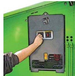
Haupt- und Motorschutzschalter am Schaltschrank von aussen bedienbar
