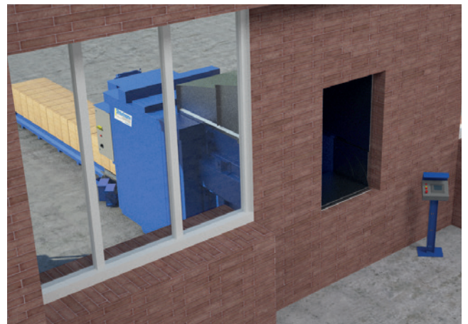
Befüllung durch Wandanschluss
